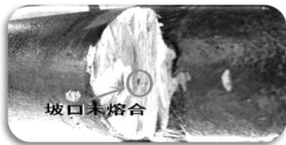
图11 DZX-198焊口打磨发现缺陷图示
