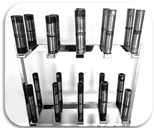
图2 小径管相控阵超声检测部分模拟缺陷试样
