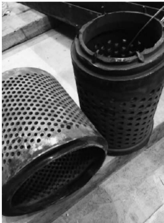
图3 断裂的二、三级减压器
