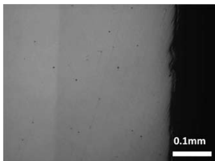
图 2a 1Cr11MoNiW1VNbN 渗层显微照片 (未腐蚀)
