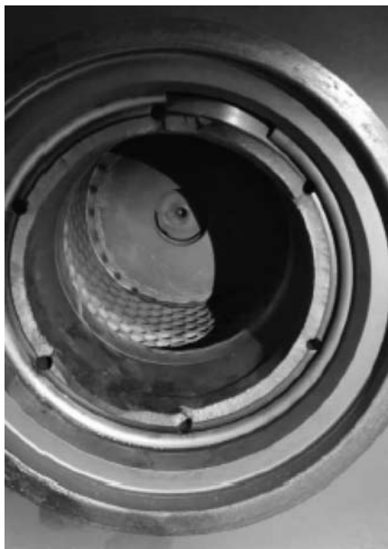
图 5 减压阀笼断口
