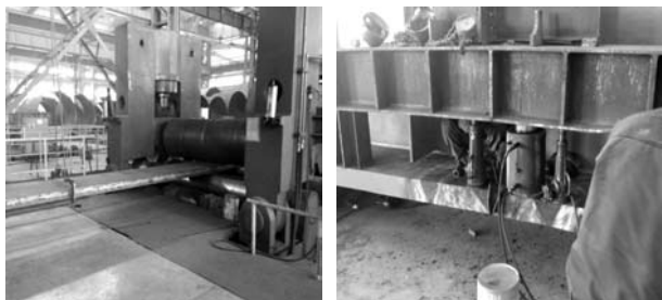
图 18 利用专用机械等外力方式进行矫正↑
