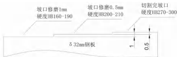
图 9 储罐钢板气割后坡口硬度检测结果示意图
